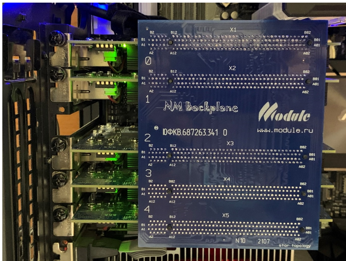
Рисунок 2.23 – Пример использования платы коммутации NM Backplane ЮФКВ.468343.007
