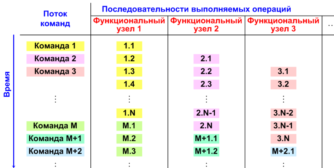
Рисунок 2.4 - Векторно-конвейерная организация вычислений (динамический VLIW)
