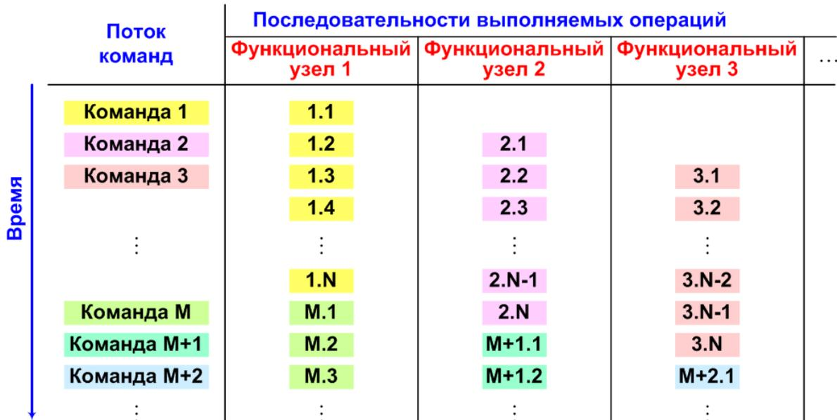
**Рисунок 1.8 - Векторно-конвейерная организация вычислений (динамический VLIW)**
