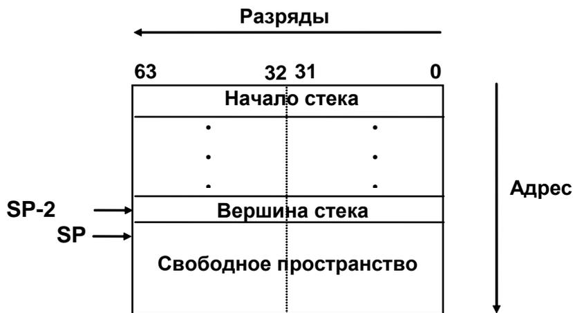
**Рисунок 5.1 - Конфигурация системного стека**
