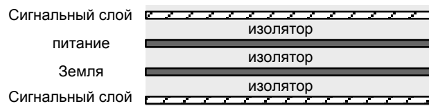
Рисунок 13.12 – Пример структуры печатной платы
