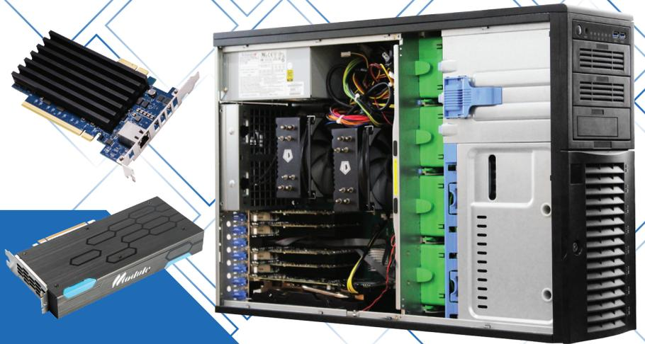
Блок NM Desktop – это рабочая станция на базе линейки отечественных процессоров Эльбрус с модулями NM Card Mini или NM Quad с архитектурой NeuroMatrix®. Решает задачи цифровой обработки сигналов и машинного зрения с помощью нейронных сетей на модулях NM Card Mini или NM Quad.
