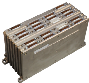
устройство VM-БИВК, выполняющее функции вычислительной машины
