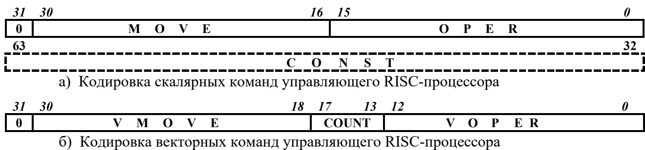
Рисунок 2.2 – Кодировка команд управляющего RISC-процессора
