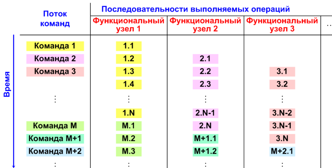
Рисунок 2.4 - Векторно-конвейерная организация вычислений (динамический VLIW)
