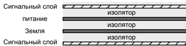
Рисунок 13.12 – Пример структуры печатной платы
