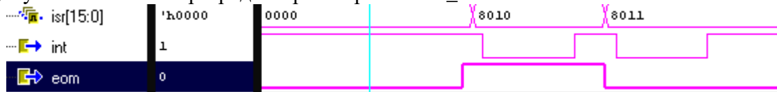
Рисунок А.3.1 - Формирование прерывания scw_e
