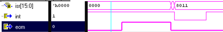
Рисунок А.3.2- Формирование прерывания scw_e
