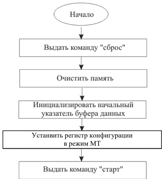
Рисунок 8.1 – Инициализация монитора слов
