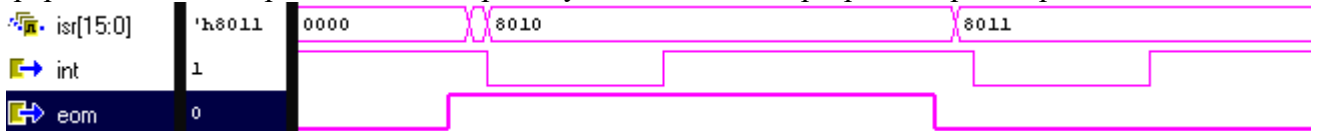
Рисунок A.2.1 - Формирование прерывания scw_e
